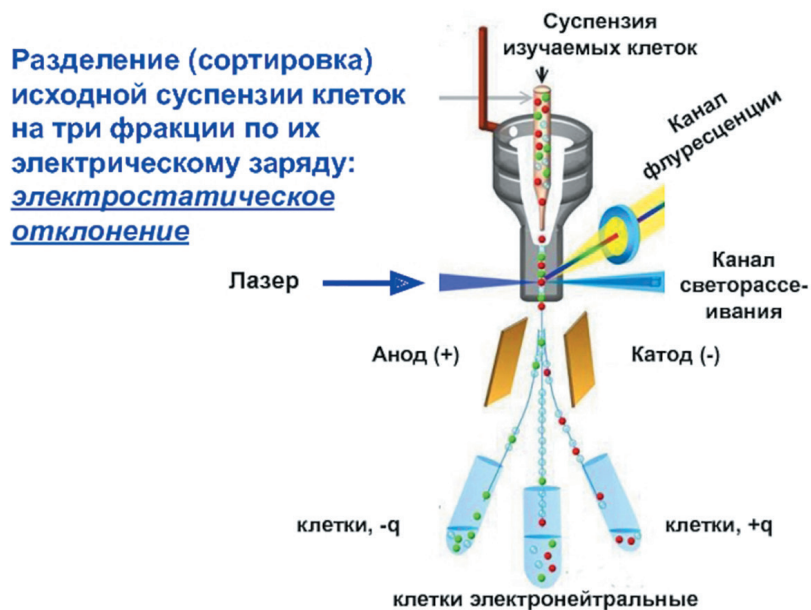
Рис. 3. Упрощенная схема проточного цитометра с функцией сортировки клеток [4]
