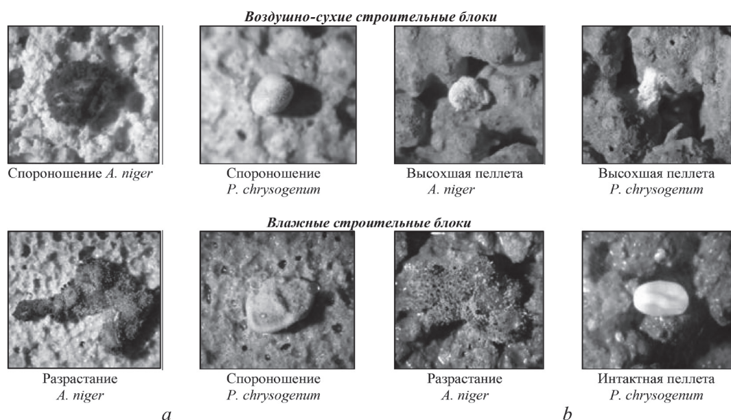
Рис. 2. Состояние пеллет A. niger и P. chrysogenum спустя 21 сут инкубирования на газосиликатных (a) и керамзитобетонных (b) блоках в сухом и увлажненном виде
