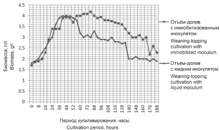
Рис. 3. Динамика биомассы бактерий B. amyloliquefaciens БИМ В-439Д при отъемно-доливном культивировании, D = 0,3 \text{ л/ч}^{-1}
